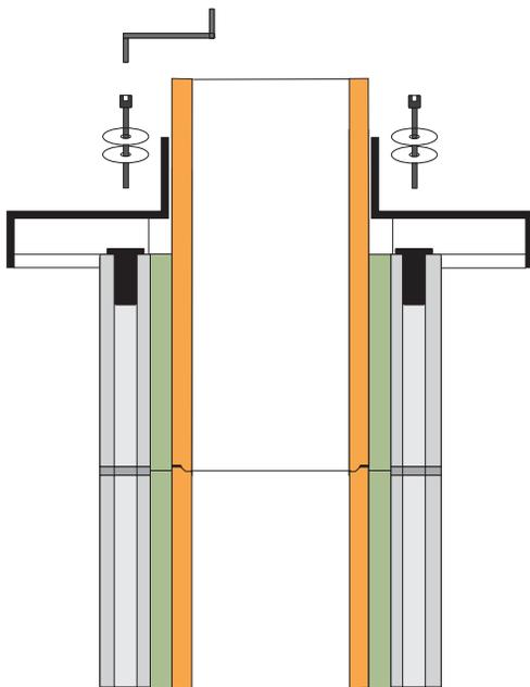
Abdeckplatte aufsetzen, 4 x Inbusschrauben mit Metallscheiben und Gummischeiden gleichmäßig eindrehen und handfest anziehen.
