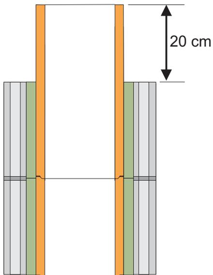
Letztes Rohr 20 cm über Oberkante Mantelstein abschneiden. Ggf. hier Dämmung entfernen.
