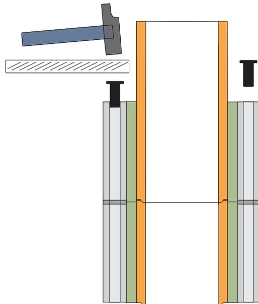
Ecklöcher prüfen und ggf. reinigen. Dübel vorsichtig mit einem Gummihammer oder einer Holzunterlage in die Löcher einschlagen.
